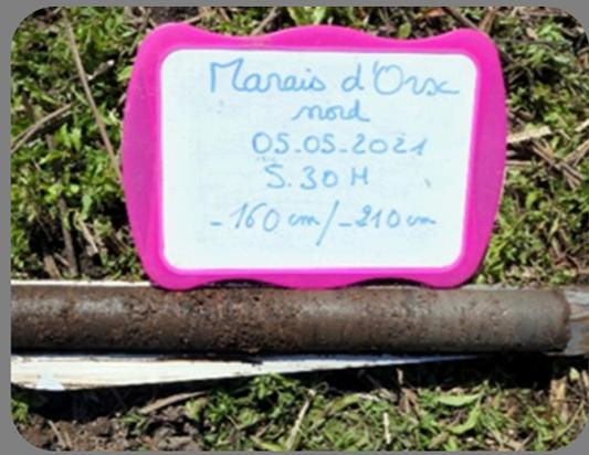
Extraction de séquences sédimentaires dans le marais d'Orx : carottage de tourbe (2021) et carottage moteur pour les sédiments sableux profonds (2024)
